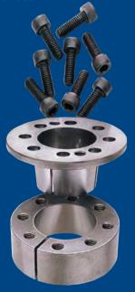
Trantorque GT Spannsätze beseitigen die Wellenschwachstelle, die durch das Einfräsen von Nuten entstehen kann. Da keine Nut in die Welle eingefräst werden muß, kann eine vorgegebene Wellenabmessung größere Drehmomente übertragen und man kann den Wellendurchmesser und Bauteile verkleinern, so daß die Größe, das Gewicht und die Kosten reduziert werden können. Außerdem, sind die Toleranzen nicht so kritisch wie bei einer Keilnutverbindung, d. h. kostenreduzierender Einsatz von preiswerten und
